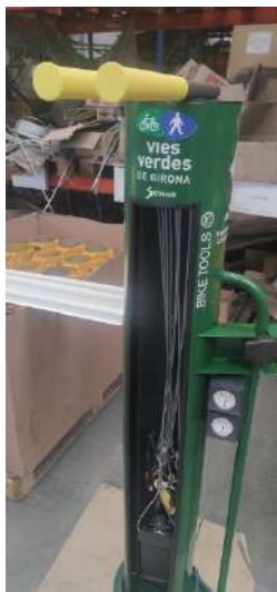
Foto 8. Tòtem de punt d'auto – reparació
